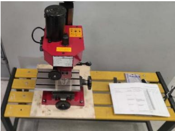
Вертикально фрезерный станок, оснащенный щитком – экраном из оргстекла
