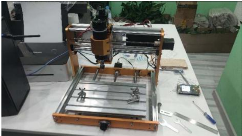
Фрезерно-гравировальный станок с числовым программным управлением, оснащенный щитком-экраном из оргстекла
