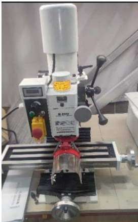
Вертикально фрезерный станок, оснащенный щитком – экраном из оргстекла
